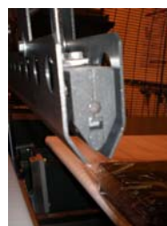
Barra de soldadura continuamente aquecida com possibilidade de alterar o perfil de soldadura
