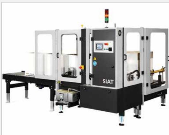
Equipamentos para formação e fecho de caixas, desde desenroladores manuais, até estações de embalagem completamente automáticas, com formação e fecho de caixas:
